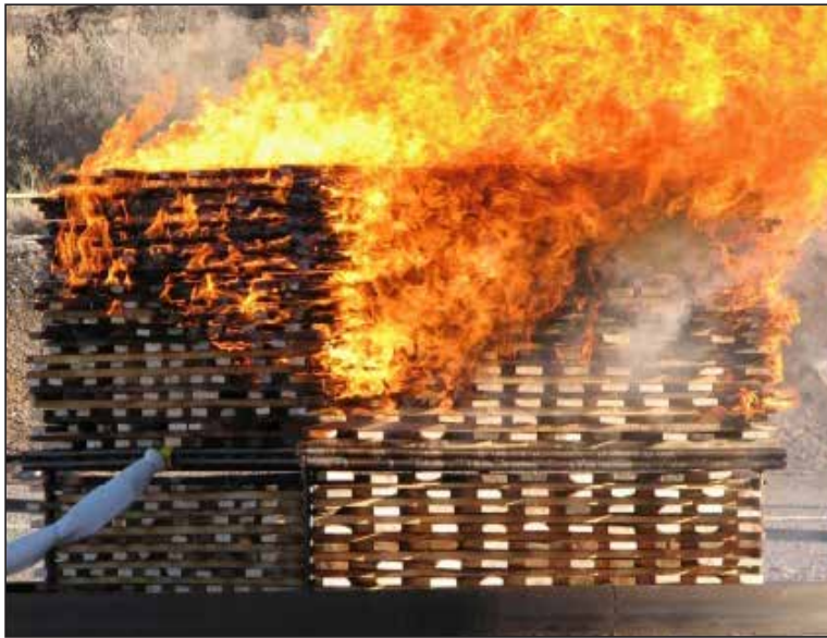
Slika 2. Test eksplozivnog materijala na ponašanje u požaru u jednom od testova iz serije 6
