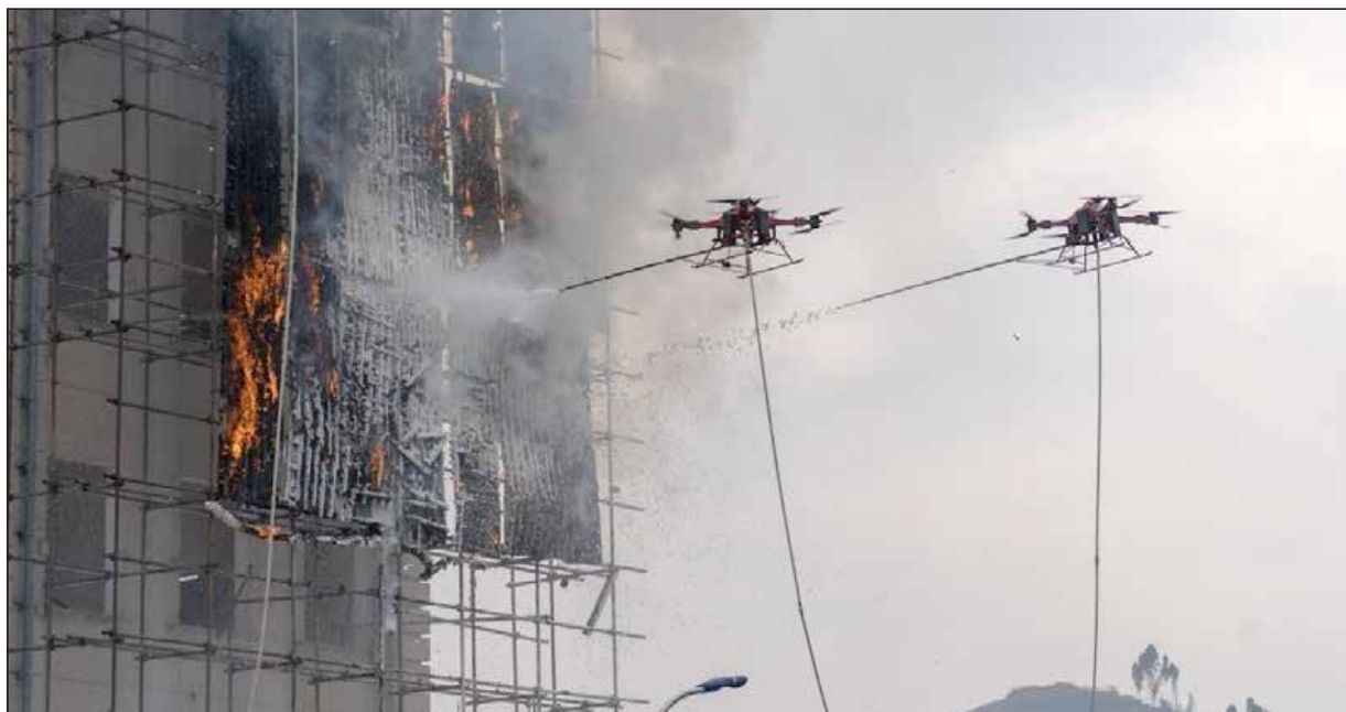
Slika 5. Latvijski vatrogasni dronovi mogu gasiti požare visokih objekata do visine od 300 m
